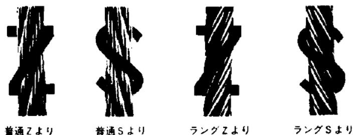
図 2.2.35 ワイヤロープのより方とより方向
